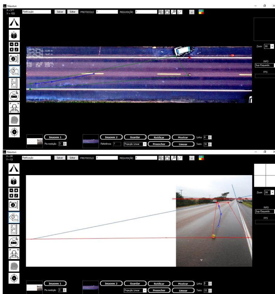
Figura 4. Imagem em perspectiva, inferior, e imagem retificada, superior.
