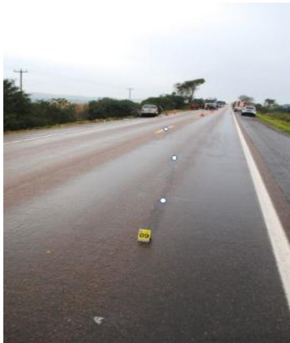
Figura 3. Imagem a ser retificada, com marcação de pontos da trajetória de guinada.
