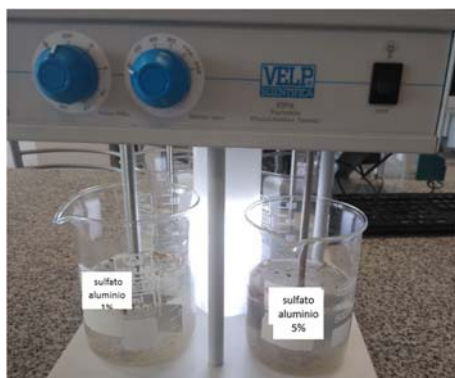
Figura 1: Muestras harina de moringa en floculador jarras con sulfato de aluminio al 1%, 2 %, 5 %, 10% y 12%.
